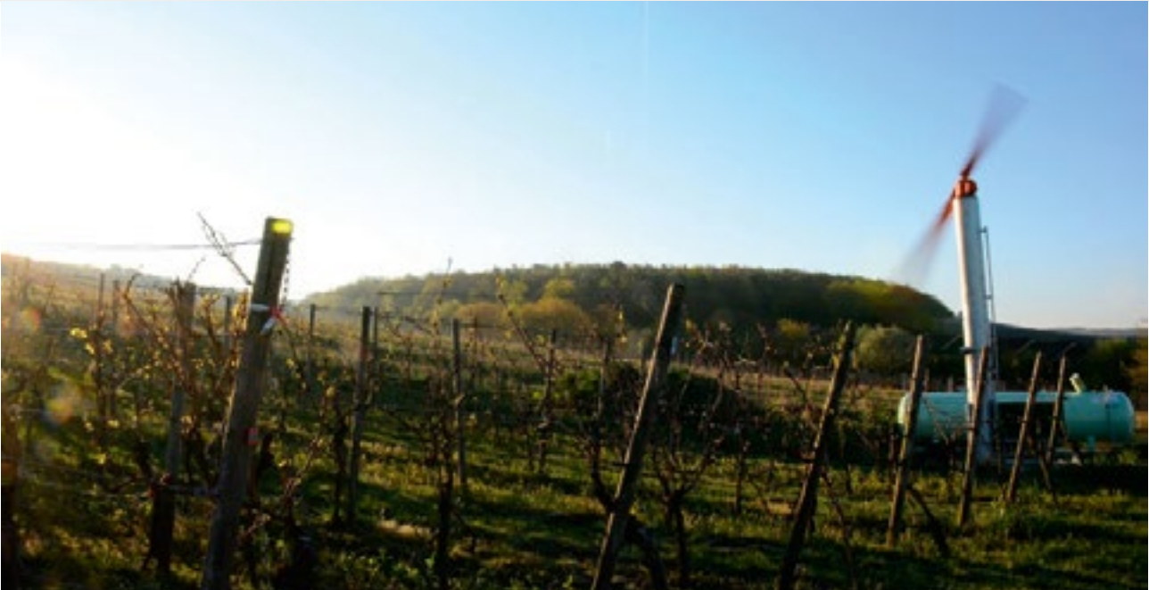
Abbildung 4.5_9: Spätfrostbekämpfung durch Windmaschinen in der Weinlage Himmelstadter Kelter
