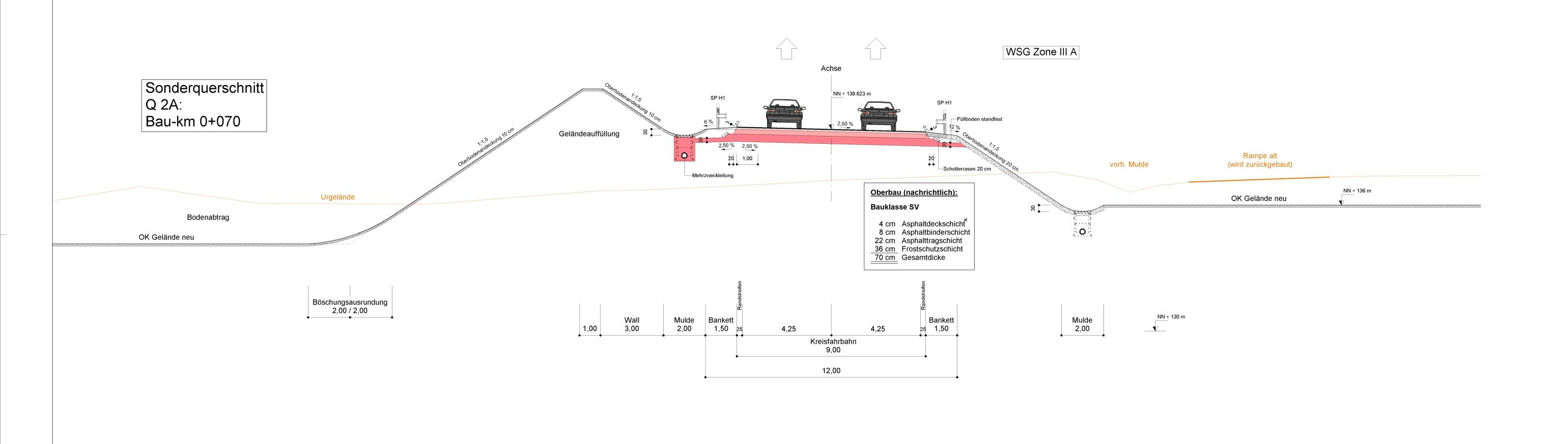
\*Asphaltdeckschicht mit einem Korrektur-Wert Dstro von -2 dB(A)
