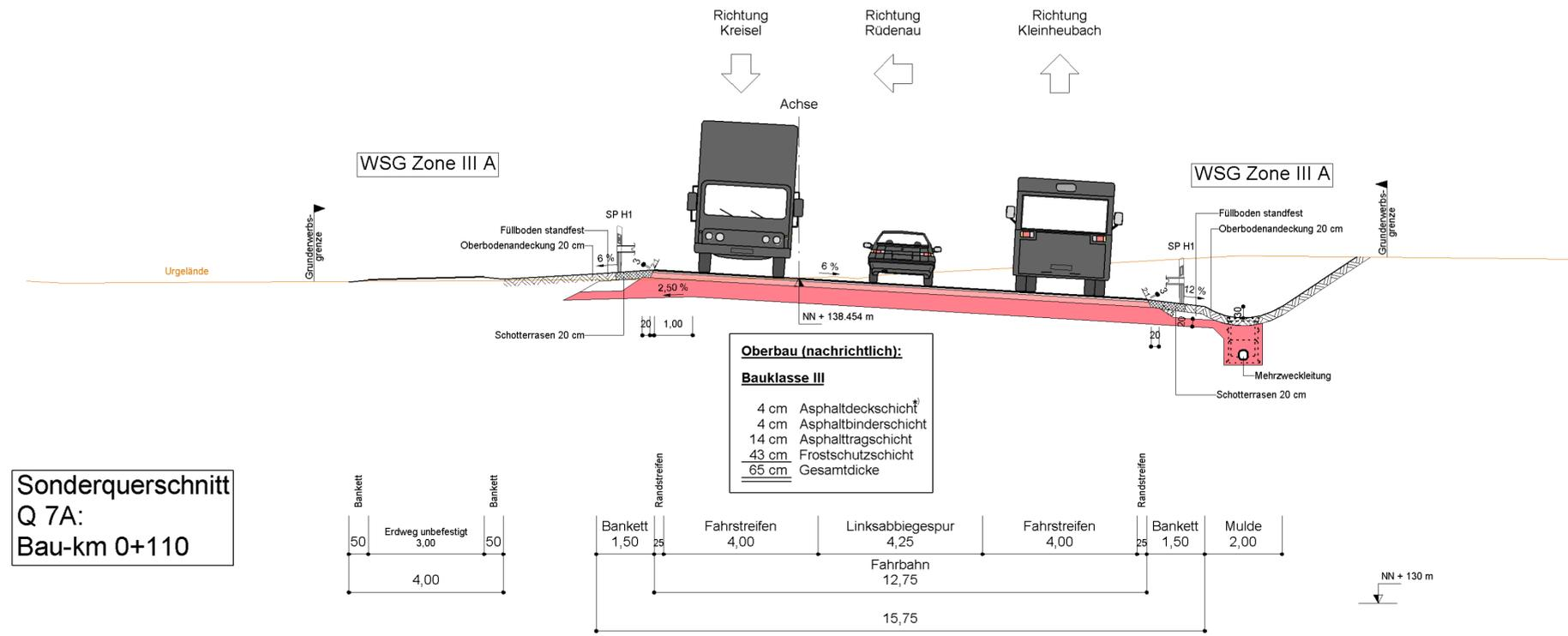
\*Asphaltdeckschicht mit einem Korrektur-Wert  $D_{tr,0}$  von -2 dB(A)
